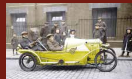
Bédélia Type BD1 de tourisme, elle est équipée d'un moteur Bédélia monocylindre 5 1/2 HP alésage 80 x 100 mm. Vendue 1850 Frs (colorisée par F. Rossi).
