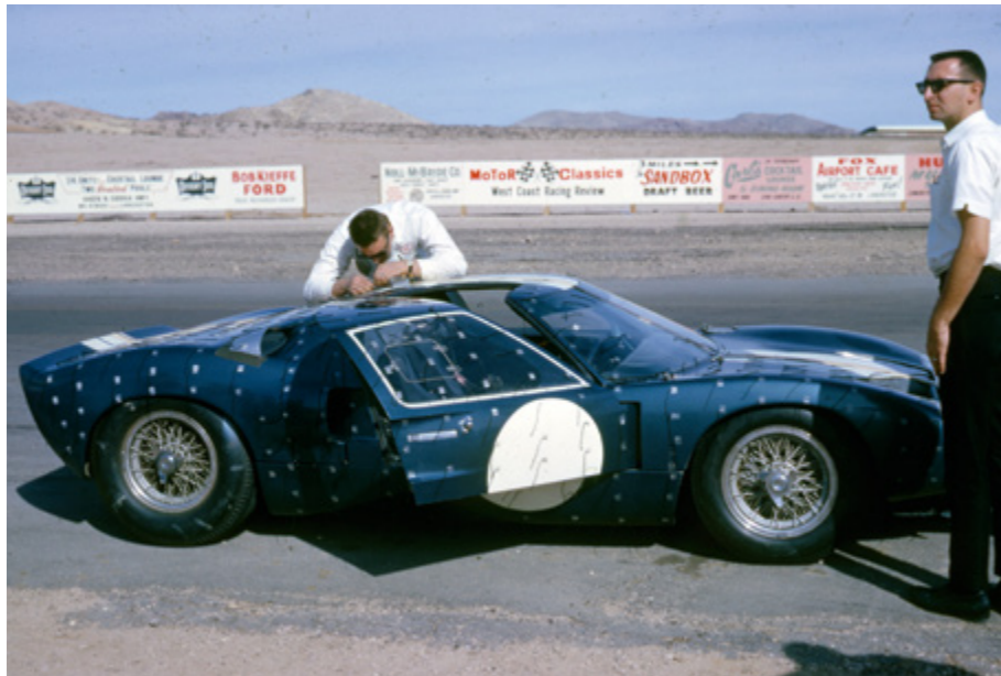
En 1965, séance de travail aérodynamique à Riverside. Lorsque la GT roule (accompagnée d'une voiture qui la filme) les mouvements des brins de laine matérialisent l'écoulement de l'air sur la carrosserie.
