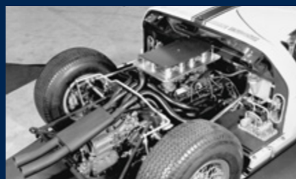
En position centrale arrière, les concepteurs ont installés le V8 4,7 litres dérivé de la Ford Fairlane couplé à une boîte-pont Colotti.
