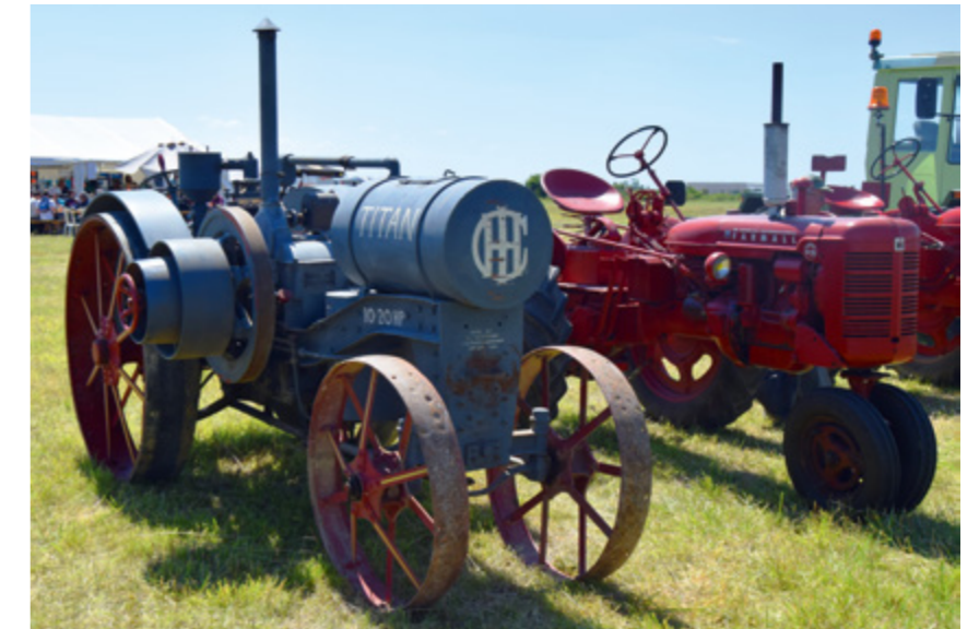
Au centre du plateau agricole, cet International Harvester Titan de 10-20 HP construit à Chicago dispose d'une puissance de remorquage de 10 HP et une puissance à la poulie de 20 HP.
