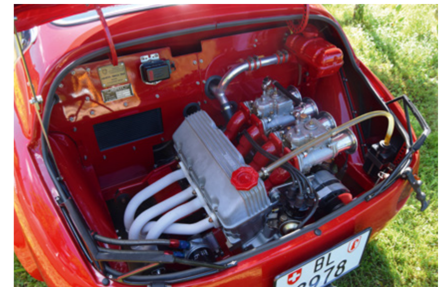
Délivrant ici 125 ch, ce moteur Simca 1300 de 1963 revisité par le sorcier Carlo Abarth est installé dans une berlinette de la marque au scorpion développée sur la base de la Simca 1000.
