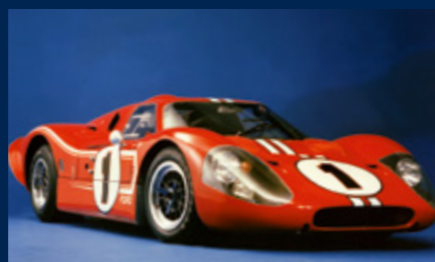
La Ford GT Mk IV est une voiture totalement nouvelle, très en avance sur la concurrence. Son châssis en composites intègre le V8 7 litres de la Mk II.
