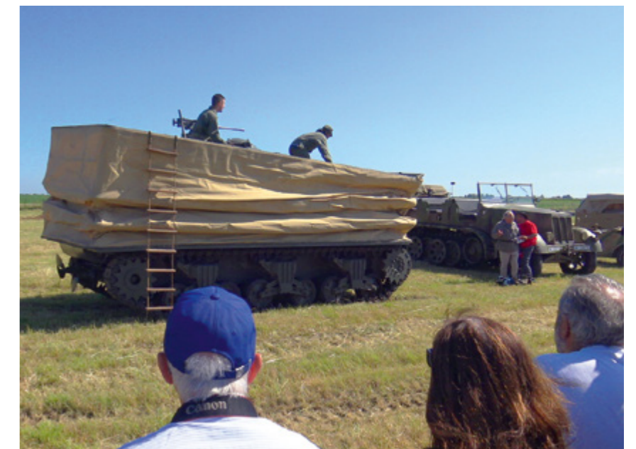
Sur le terrain réservé aux véhicules militaires, cette reconstitution de Sherman DD montre le principe de fonctionnement de la jupe de toile qui permet de le transformer en véhicule amphibie.
