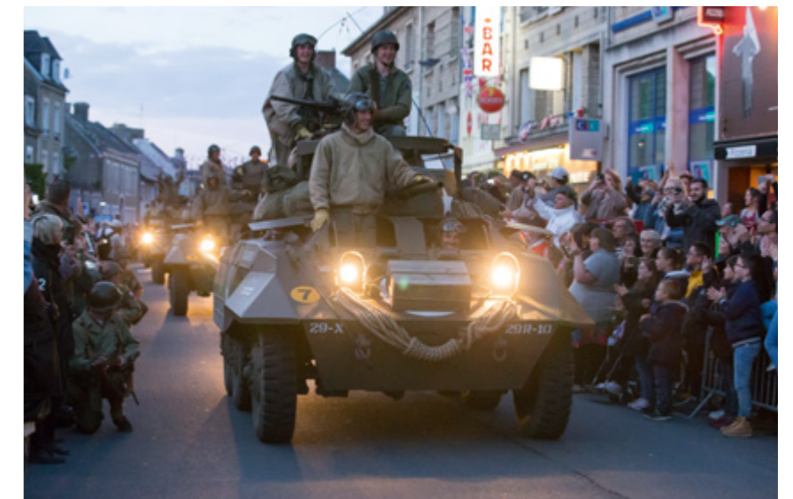
Défilé à la nuit tombante pour ces Ford M 8, véhicules blindés de reconnaissance 6 x 6. D'un poids total de huit tonnes, ils sont équipés de deux mitrailleuses et d'un canon de 37 mm.
