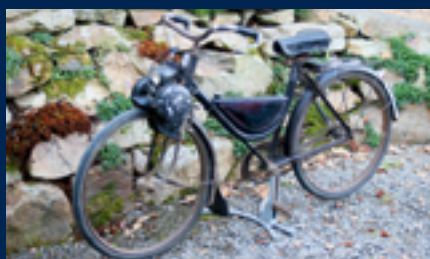
45 cc de la fin d'année. Les pièces embouties apparaissent déjà sur la partie arrière du VéloSolex. Ce modèle est équipé d'une jolie nourrice.
