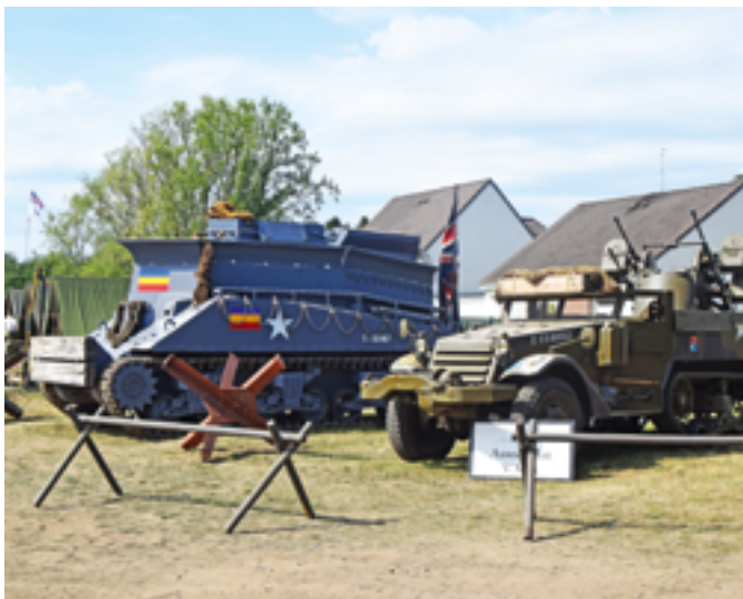
Rareté absolue que ce Sherman de dépannage imaginé pour dégager les véhicules lourds en panne sur les plages. A ses côtés, un half-track.
