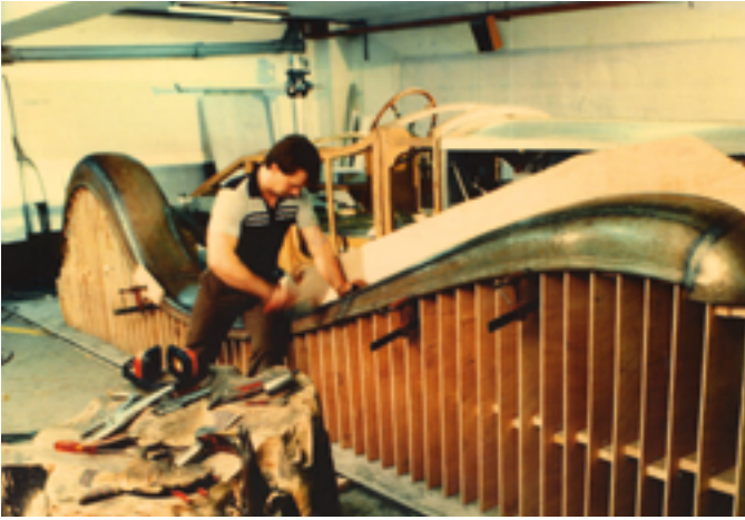
Fabrication de la carrosserie de la Royale Esders chez le carrossier Lecoq à Saint-Ouen. L'exceptionnel travail des tôleurs-formeurs est une œuvre en soi.
