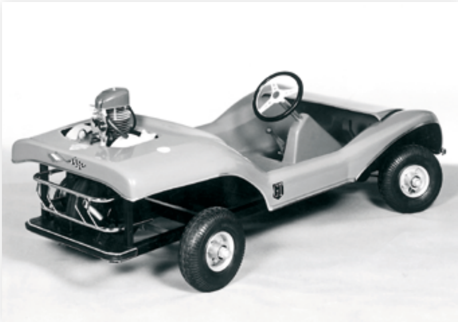
Les Ets Bellier fabriquent plusieurs centaines de « Formule 85 » pour les enfants. Le moteur entraîne une cinquième roue reliée à l'essieu arrière.
