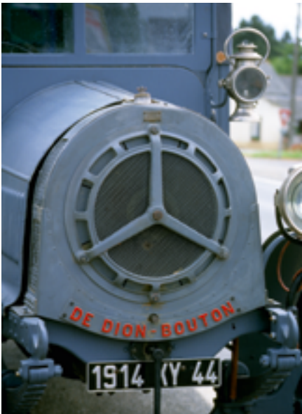
Le radiateur centrifuge de «Goudard et Mennesson» équipe bon nombre de poids lourds et quelques 400 autobus parisiens.
