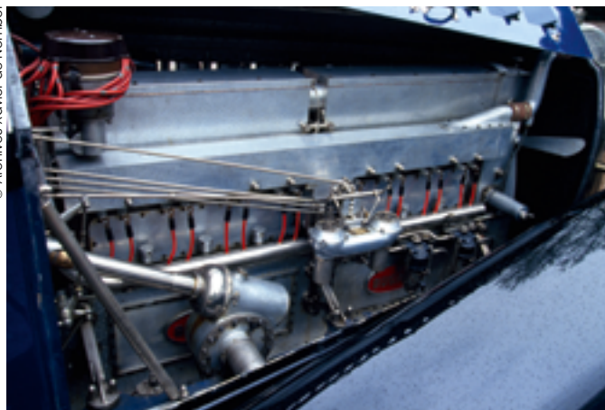
Véritable sculpture de métal noble, l'ensemble du moteur est embelli par grattage, guillochage ou bouchonnage.
