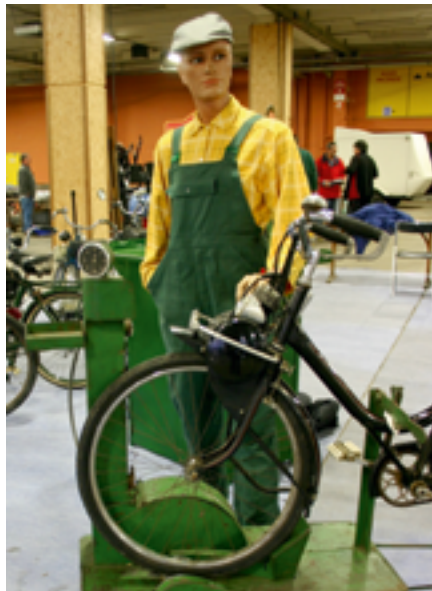
Le service Après-Vente impose le matériel de maintenance aux concessionnaires. Le banc d'essai valide les réparations sans essai routier.
