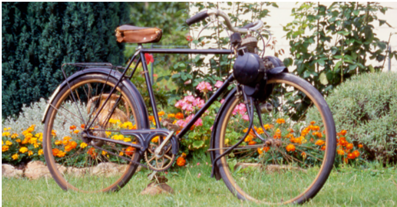
Le moteur Solex N°23 de présérie monté sur un cadre d'homme Alcyon. A noter la présence du phare occulté, sous le moteur.
