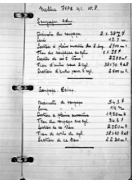
Le carnet du banc d'essais des séries de moteurs d'autorail type WR. Ils étaient très proches des blocs qui équipaient les Royale.
