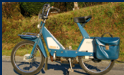
Le Flash, tentative pour sauver VéloSolex, sort trop tôt. Transmission par arbre, refroidissement par turbine et frein à disque sont trop en avance sur leur temps.
