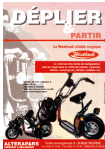
Le Westhoek est une invention belge du début du 2 e siècle. Plus de béquille! C'est le cadre qui se pose au sol lorsque l'engin est replié.
