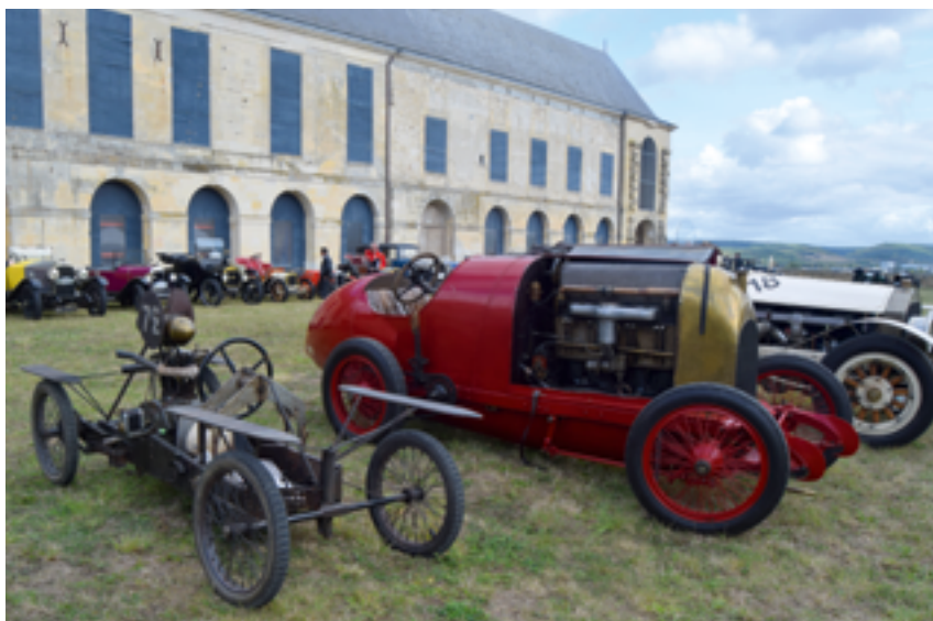
Les deux extrêmes : Fiat S76 de 1911, à droite, surnommée « la Bête de Turin », motorisée par un 4 cylindres de 28 litres et Elfe Laboratoire, monoplace de 1921 à moteur 1100cc.
