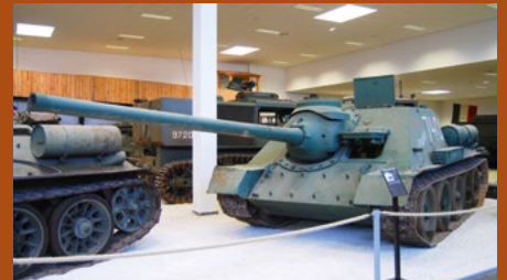
Recevant un blindage de 75 mm, le SU 100 soviétique était capable de détruire tous les chars allemands à l'exception du fameux Königstiger ou Tigre Royal.
