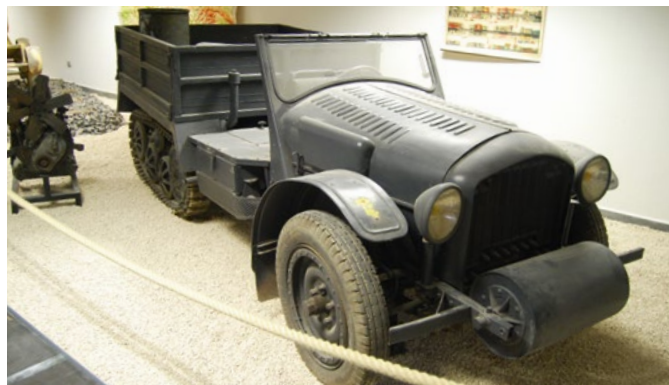
Produit à 236 exemplaires, ce tracteur d'artillerie Unic TU 1 est adopté par l'armée française en 1939 pour tracter un canon antichar de 25 mm.
