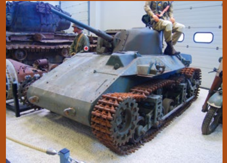
Char léger américain destiné aux Britanniques, le M 22 Locust pèse 7,4 t et a été étudié pour être aérotransportable en avion ou en planeur.
