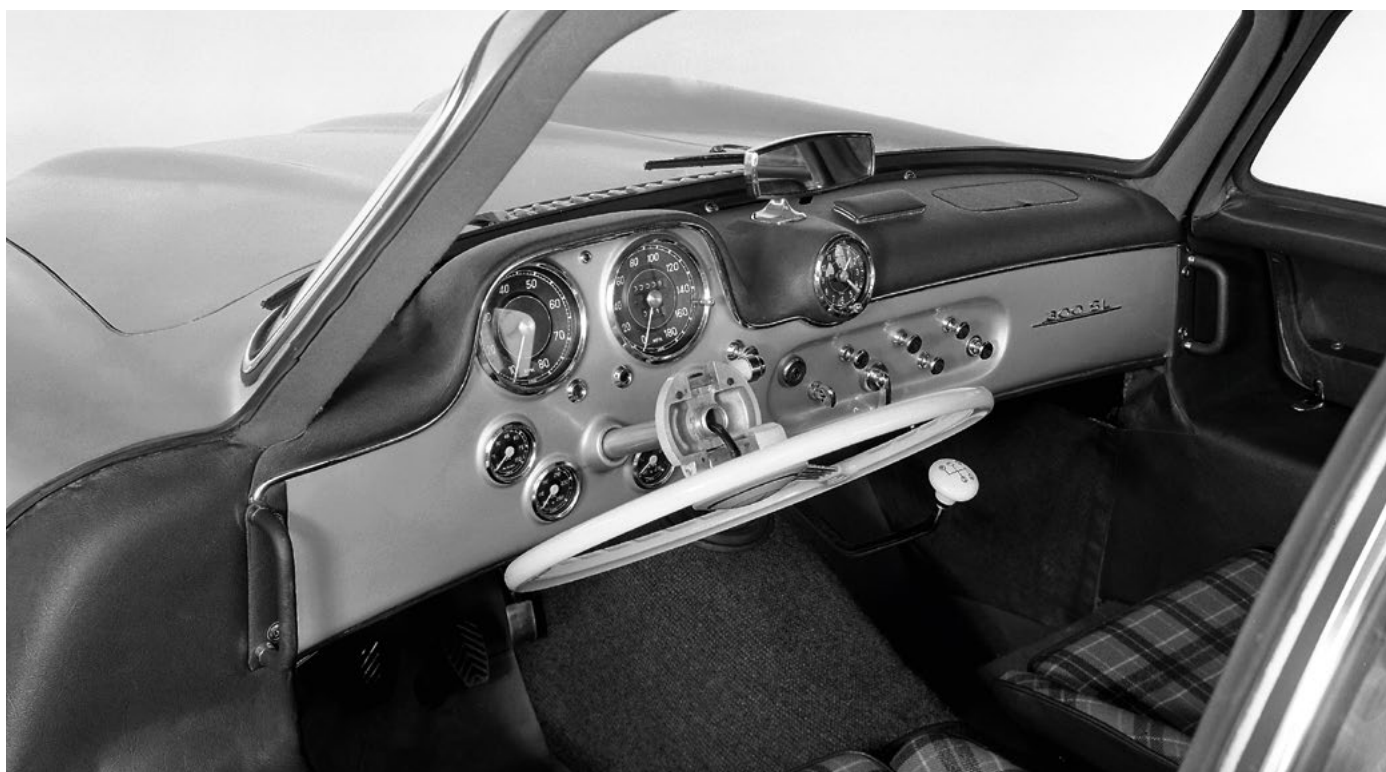
L'ingénieux système de volant basculant qui permet au conducteur de s'introduire plus facilement dans l'habitacle de la 300 SL.
