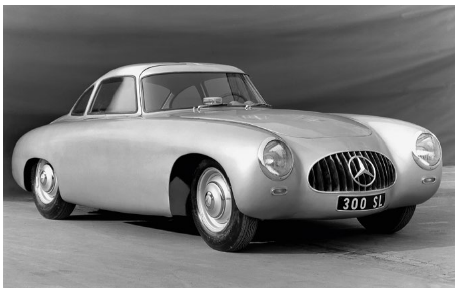
Mars 1950, la Mercedes 300 SL, châssis n°1. Pour le moment, la voiture est exclusivement destinée à la compétition. La découpe des portes s'arrête au ras des glaces.
