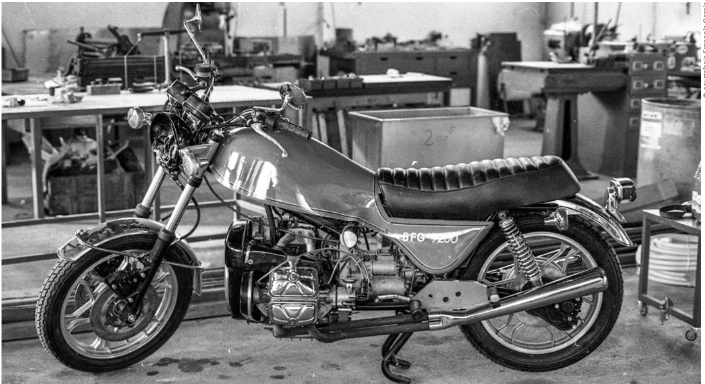
En 1978, à Vendôme dans l'atelier d'Alain Chevallier, le premier prototype de Louis-Marie Boccardo à mécanique Citroën GS est en voie d'achèvement.
