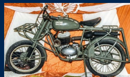
En 1959, Gnome & Rhône étudie pour l'armée ce prototype 125 P parachutable avec roues de 16 pouces et suspension arrière à bloc caoutchouc.
