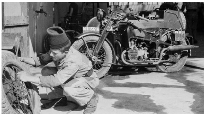
Efficace, fiable et sans sophistication technique, la 800 AX 2, utilisée de 1938 à 1946, s'est affirmée comme l'un des attelages militaires les plus homogènes.
