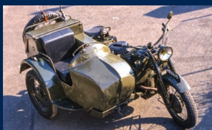
Une 800 AX 2 de 1940 avec la très lourde caisse Bernardet. La Wehrmacht lui préférera la caisse plus légère conçue pour Gillet Herstal.
