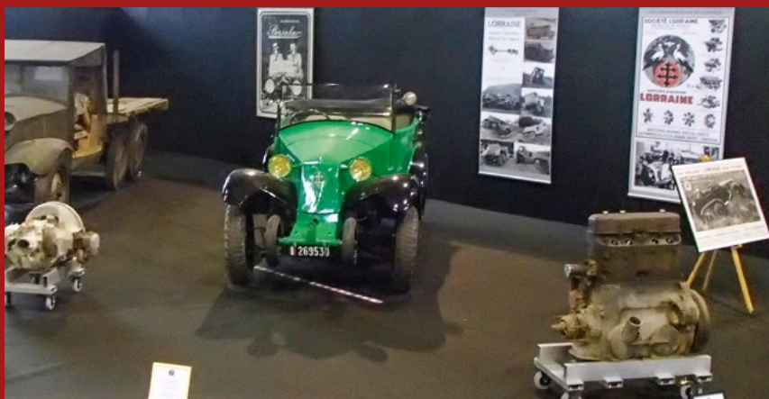
1932-1938, Type 72, véhicules tout terrain militaires 6 x 4 à six roues indépendantes, licence Tatra.
