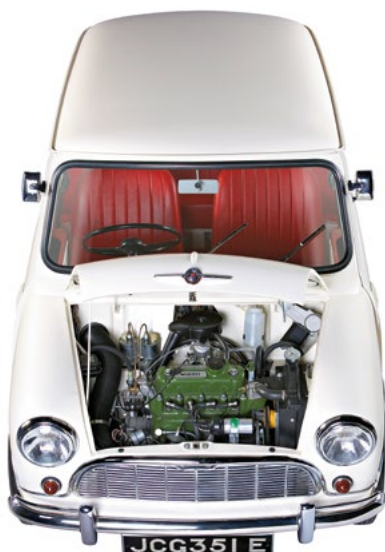
Le compartiment moteur est bien rempli. Ne cherchez pas la boîte, elle est sous le moteur et le radiateur placé sur le côté gauche.
