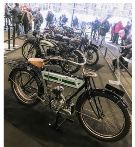
Cette Triumph 3,5 ch de 1911 offre la possibilité de démarrer et de s'arrêter sans en descendre grâce à un embrayage installé dans le moyeu arrière.
