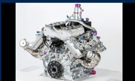
Le plus surprenant dans la 919 Hybrid est le choix de son moteur V 4 de 2 litres de cylindrée suralimenté par un turbocompresseur.
