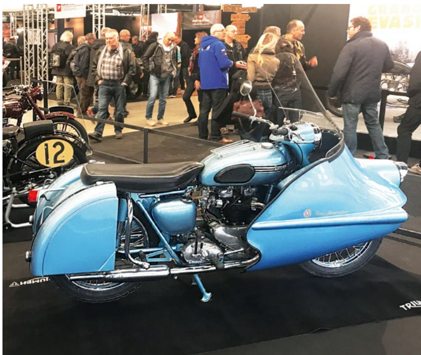
Triumph Thunderbird 650 cm 3 1955-1957 équipée d'un carénage Avon Streamliner, d'arceaux Britax et de sacoches Rodark. Il n'en resterait que trois exemplaires !
