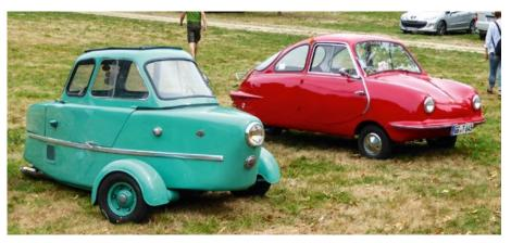
Un des trois Inter Autoscooter présents au côté d'une Fuldamobil S 7 de 1959. Cette dernière, venue d'Allemagne, est équipée d'un moteur monocylindre deux temps refroidi par air Fitchel & Sachs de 191 cm³.
