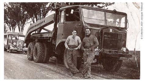
Destiné à l'armée française, le Willème DW 12 A, un porte-char 6 x 4 équipé d'un moteur Diesel Deutz de 11 536 cm³, reçoit une cabine avancée dans sa version 1937.
