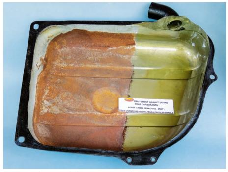
Avant et après... La «restomisation» permet, sans les ouvrir, de nettoyer puis protéger les réservoirs avec une résine anticorrosion résistant à tous les carburants.
