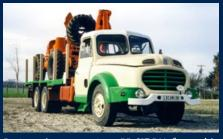
Porteur de grumes type RD 615 DN d'un poids total roulant de 26 tonnes.
