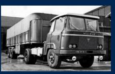
Tracteur LF 202 équipé d'un moteur AEC à six cylindres développant 230 ch.
