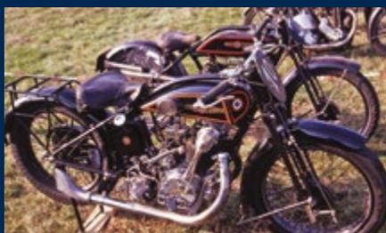
La Kæhler 500 K 50 née fin 1927, à double tube d'échappement et ressorts de soupape hélicoïdaux, a servi de base à l'élaboration de la version course.
