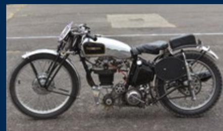
*Boîte de vitesses séparée et magnéto entraînées par chaînes depuis l'arbre de sortie moteur et suspension arrière Monet-Goyon coulissante.*
