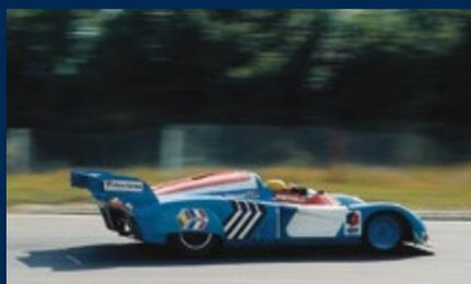
Essais aérodynamiques pour l'Alpine A 441 à moteur V 6 atmosphérique. Les passages de roues arrière sont ici carénés.
