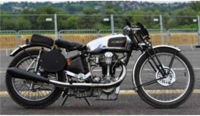
La 350 Kœhler de Grand Prix de 1936. Le carburateur est à corps horizontal et, sur le cadre simple berceau interrompu, a été montée la suspension arrière coulissante Monet-Goyon.
