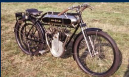
*Mandoline 1914. Un tube unique d'échappement relie les sorties des deux cylindres, les gaz s'échappant par des trous au bas de cette boucle.*
