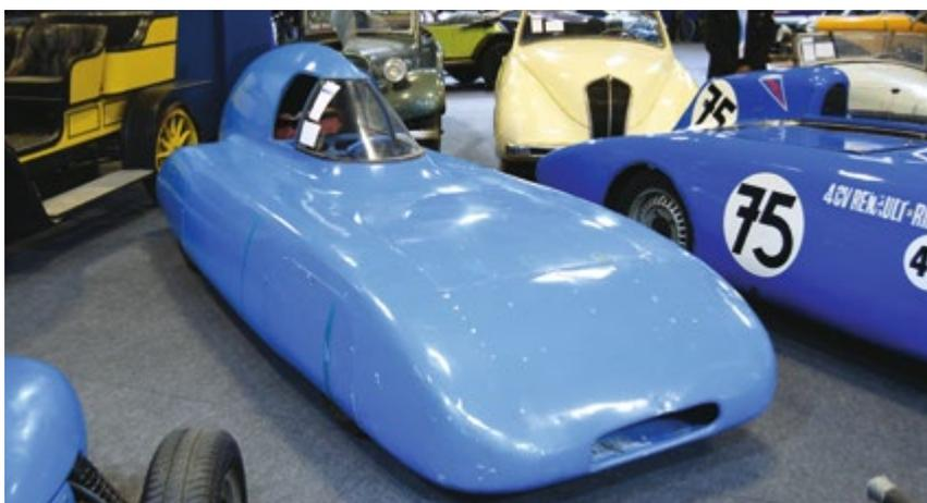
Parmi les autos de la collection Broual mises aux enchères, la De Coucy des records de 1948 à carrosserie aluminium était prévue pour recevoir un moteur à quatre cylindres de 500 cm<sup>3</sup> à distribution rotative. Elle était ici proposée avec un moteur de 1100 cm<sup>3</sup> à deux arbres à cames en tête.
