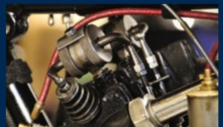
*Les culbuteurs « en queue-de-cochon » de la Mandoline Sport tournent sur deux roulements à billes et les doubles ressorts sont en tronc de cône.*
