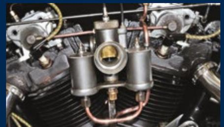
La 1000 Quatre Tubes est alimentée en essence/benzol par un, ou parfois deux, carburateur double cuve Amal de 27 mm.
