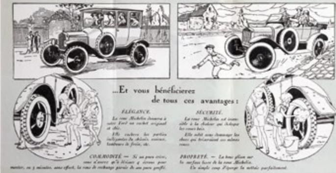
Conscient du succès de la Ford T en Europe, mais aussi de la fragilité de ses roues à rayons de bois, Michelin proposera des moyeux spécifiques permettant le montage de roues en tôle emboutie de sa fabrication.
