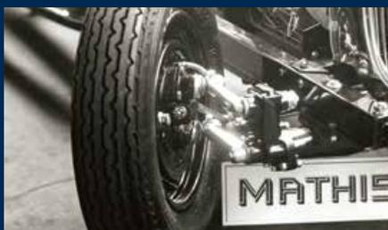
Détail de l'essieu avant Quadruflex à barres de torsion et roues indépendantes, système Porsche, monté sur les M 4 S à partir de 1933.
